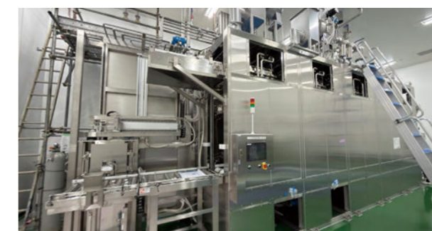
コンテナ洗浄機
